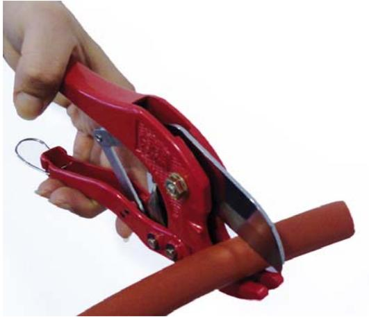
1. Couper le tube de façon propre et perpendiculaire avec un coupe-tubes.
